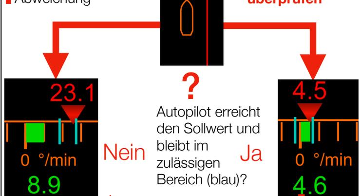
! Strömungsgeschwindigkeit überprüfen
