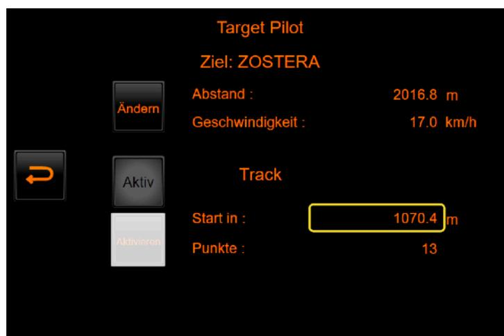
Wenn der Abstand zum Start der aufgezeichneten Linie 0 ist und der argoTrackPilot nicht aktiv ist, wird die Schaltfläche „Aktivieren“ freigegeben, und der argoTargetPilot kann aktiviert werden. Danach kann der argoTrackPilot mit der vom AIS-Ziel aufgezeichneten Linie genutzt werden. In der Hauptoberfläche des argoTrackPilot wird, solange der argoTargetPilot aktiv ist, ein Hinweis angezeigt, dass einem AIS-Ziel gefolgt wird.
