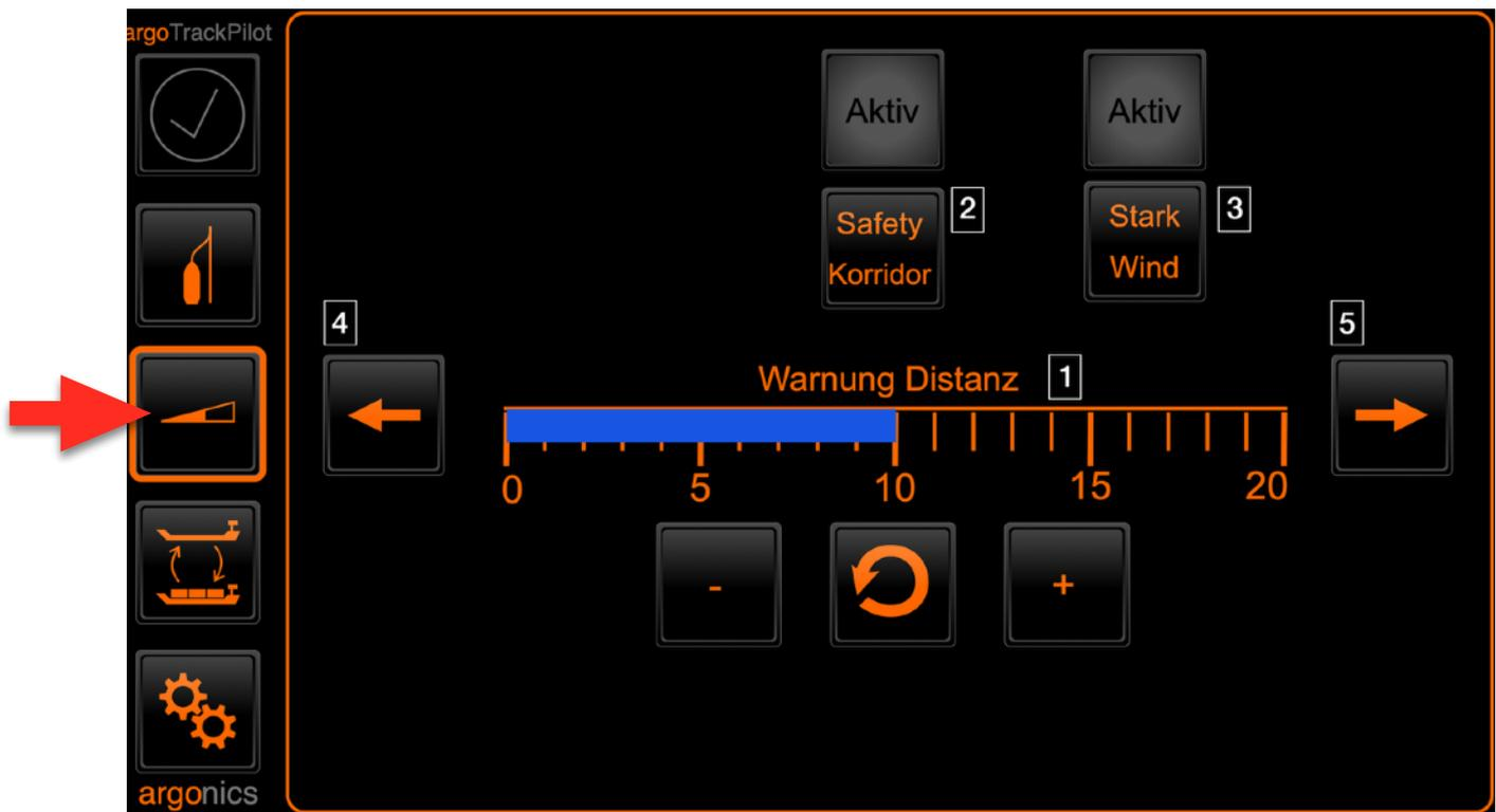
1. Abstand Warnung: Über diesen Wert kann der Schiffsführer festlegen, ab welchem Abstand von der Linie er gewarnt werden möchte. Es wird allerdings nicht grundsätzlich bei einer größeren Abweichung gewarnt. Im Falle einer gewollten Verschiebung des Tracks um mehr als diesen Schwellwert kommt keine Warnung kommen. Die Warnung erscheint also nur, wenn die Abweichung größer wird, als das System erwartet.
