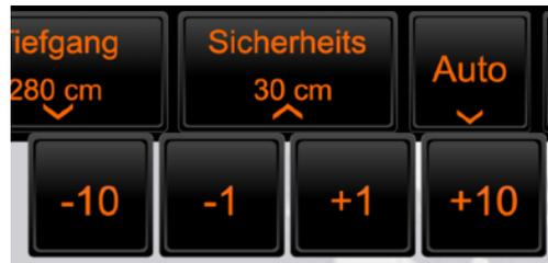
**i** Die Sicherheitsmarge muss nur eingestellt werden, wenn der Wasserstand auf „Auto“ gesetzt ist.
