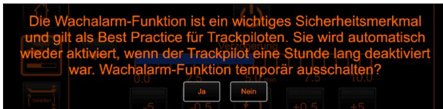
Mit einem Druck auf diese Schaltfläche kann die Überwachung temporär ausgesetzt werden. Der Wachalarm wird automatisch wieder eingesetzt, sobald der TrackPilot eine Stunde deaktiviert war. Gegebenenfalls können Sie den Wachalarm nicht aussetzen, wenn dies Ihre Reederei nicht zulässt.
