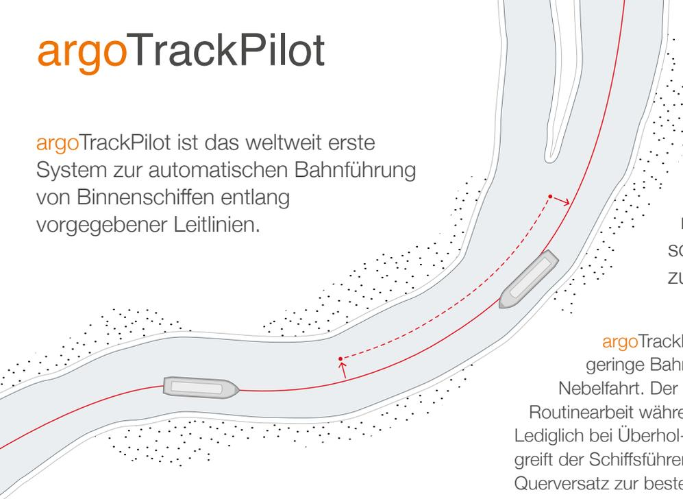
argoTrackPilot bildet damit den nächsten logischen Schritt nach dem Autopiloten (Wendegeschwindigkeitsregler) auf dem Weg zum autonomen Schiff.
